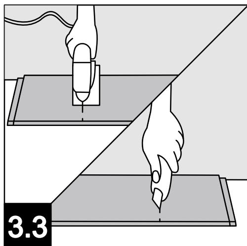
**3.3.** Для раскюя SPC «Alta Step», по прямой линии следует использовать специализированный строительный лезвийный нож. При помощи ножа прорежьте с лицевой стороны доски верхний защитный слой, затем согните доску по разрезу. Для выполнения фигурного раскюя следует использовать ручной или электрический лобзик.
